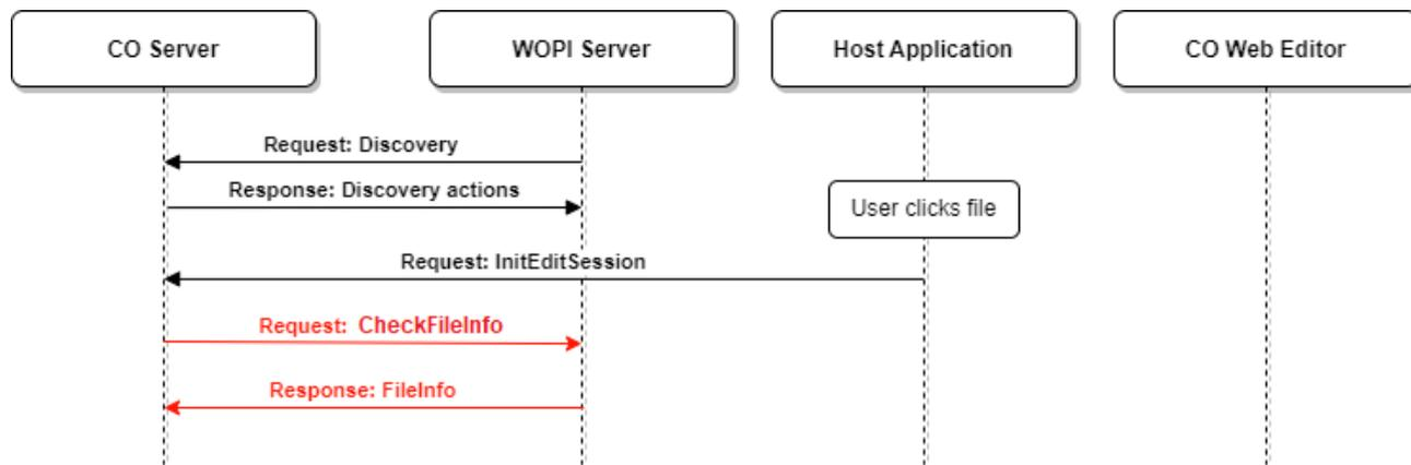
Рисунок 5 - Запрос **CheckFileInfo**
