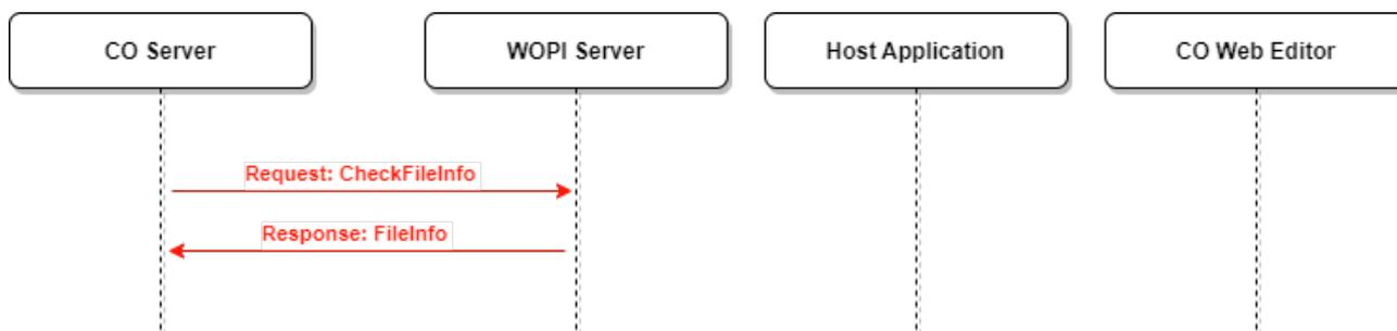
Рисунок 23 - Запрос **CheckFileInfo**
